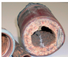
Twarda woda to zagrożenie dla kotłowni – powoduje m.in. znaczne obniżenie sprawności cieplnej instalacji grzewczej.
